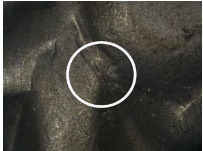
Snímka trhliny v doske výmenníka spôsobená tesnením, ktorého hrúbka je o 12% väčšia ako je požadovaná. Použitím takéhoto tesnenia došlo k vytvoreniu veľkej vzdialenosti medzi prvou a poslednou doskou výmenníka.
