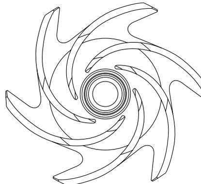
Fig. 4.1.3a Semi-open impeller
